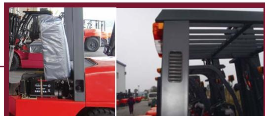
Toma de aire en parte superior previene la entrada de polvo, resultando en una mayor vida útil.
